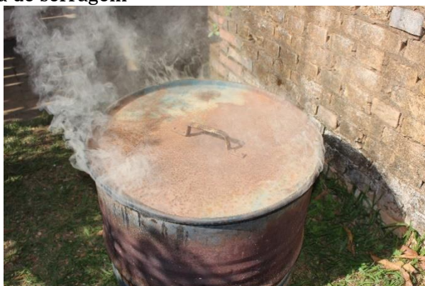
Figura 8: (b) Resfriamento dos artefatos num tambor preenchido por uma película de serragem
