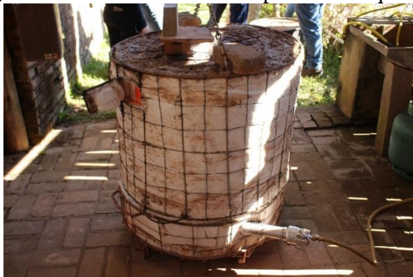
Figura 8: (a) – Forno tubular utilizado no processo de queima
