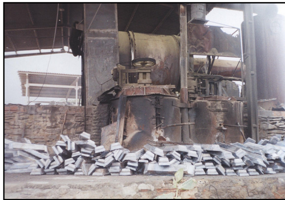
Figura 4: Forno de fundição e lingotes produzidos
