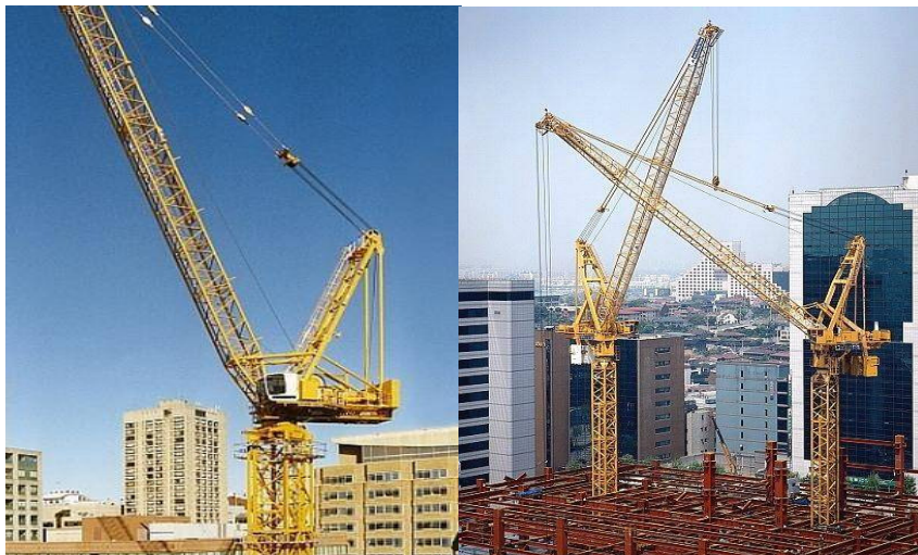
Figura 4: Fotos da torre basculante
